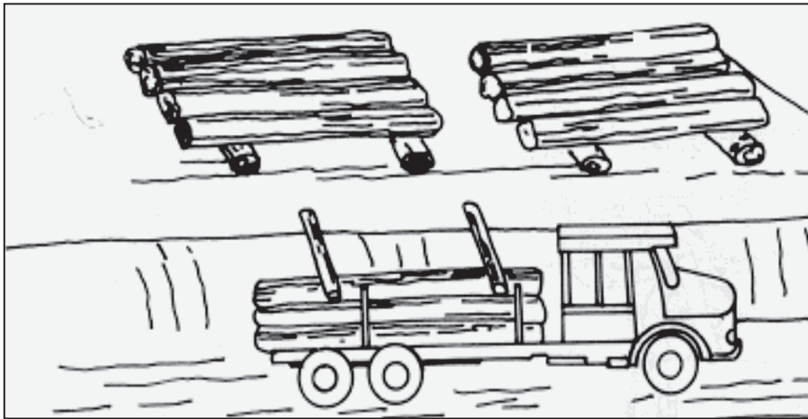
Hình 7.1. Dùng đà kê lăn gỗ xuống thùng ô tô
